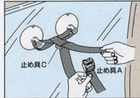
②吸着盤の止め具Cに図のようにベルトを通す。
