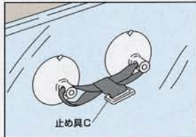
①サイドガラスの吸着面の汚れ・ホコリ等をきれいにして乾かし、吸着盤をガラス面に押し付ける。この時吸着盤内の空気を必ずきれいに抜いてください。
